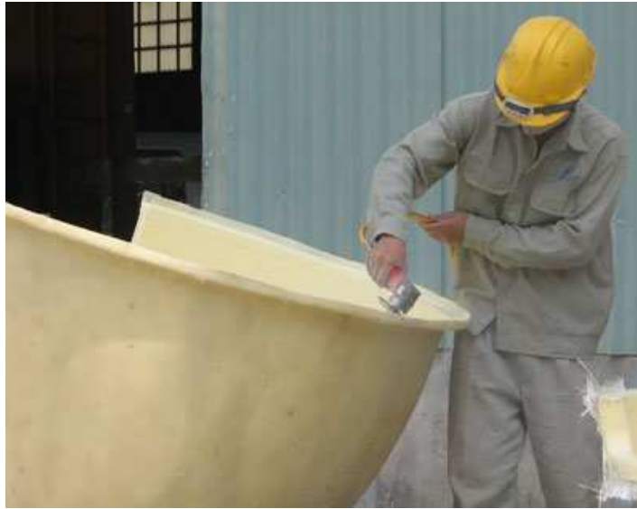
Lắp ráp khuôn bề tấm nước nóng bằng composite
