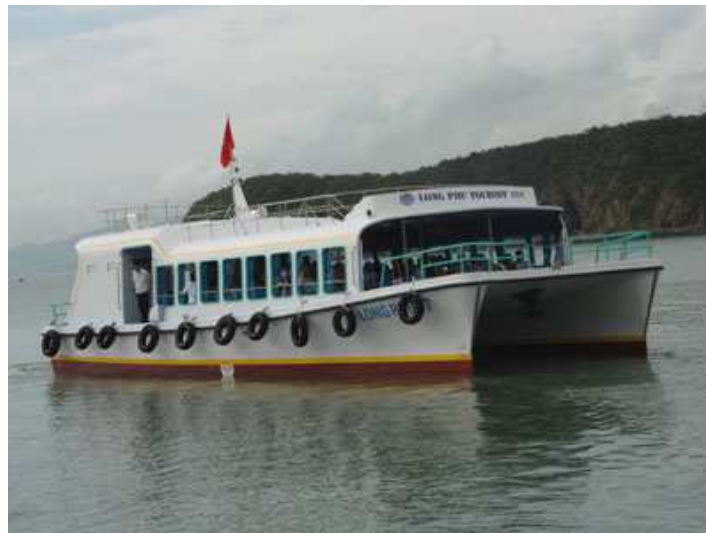
Tàu Long Phú 17 có sức chứa khoảng 100 khách được thiết kế 2 thân bằng composite
